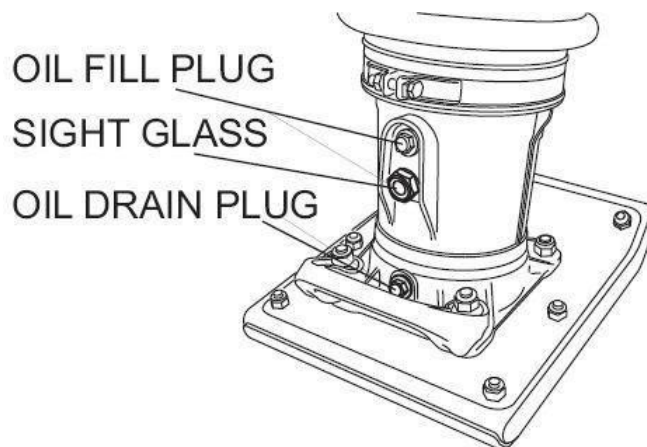
Fig. 13 Tapón de drenaje de la carcasa del pie / Foot Housing Drain Plug
