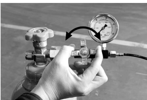
9. Abra la válvula de 3 vías lentamente, cargue gas N2 hasta 65 kg/cm 2 y cierre la válvula. / Open the 3-way valve slowly, charge N2 gas to 65 kg/cm 2 , and close the valve.
