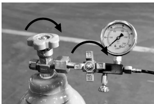
4. Cierre la válvula del cilindro de gas, conecte el kit de carga de gas al cilindro de gas, cierre la válvula de 3 vías y el grifo de drenaje. / Close the gas cylinder valve, connect the gas charging kit to the gas cylinder, close the 3-way valve and the drain cock.
