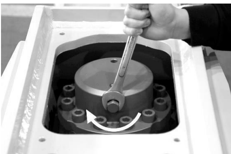
13. Ensamble la tapa de la válvula de aguja. Install the needle valve cap.
