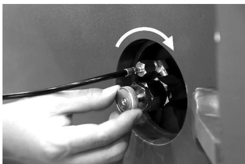
6. Apriete la sección superior del adaptador. Tighten the upper section of the adapter.
