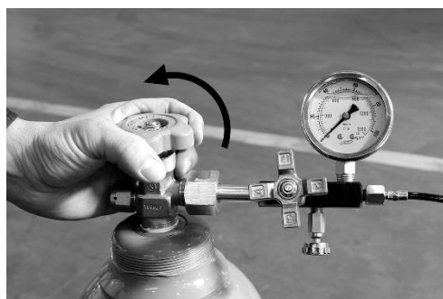
7. Abra la válvula de la bombona de gas LENTAMENTE. Open the gas cylinder valve SLOWLY. Abrirla demasiado puede dañar el manómetro. Opening it too much may damage the pressure gauge.
