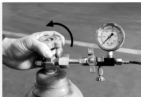
8. Abra la válvula de la bombona de gas LENTAMENTE. Open the gas cylinder valve SLOWLY. Abrirla demasiado puede dañar el manómetro. Opening it too much may damage the pressure gauge.
