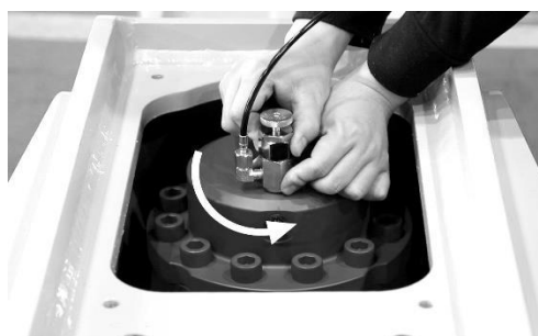
12 Retire el adaptador de carga de gas. Remove the gas charging adapter.
