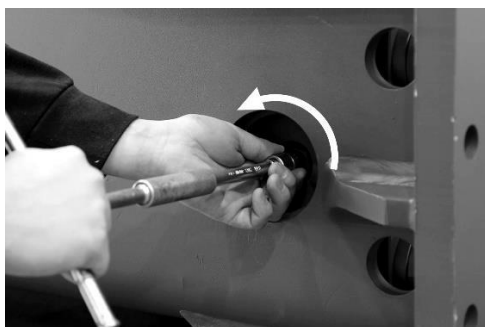
1. Retire el tapón de goma. / Remove the rubber plug.
