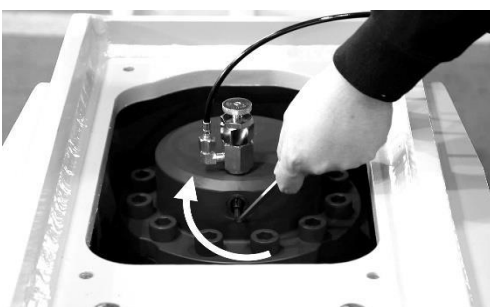
11. Cierre la válvula de aguja. / Close the needle valve.
