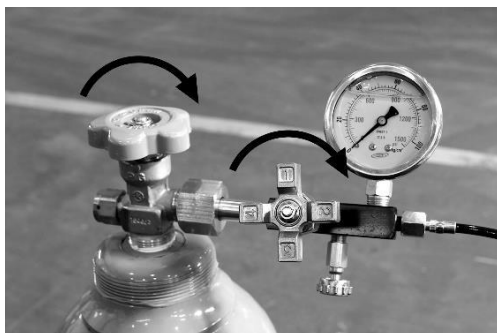
3. Cierre la válvula del cilindro de gas, conecte el kit de carga de gas al cilindro de gas, cierre la válvula de 3 vías y el grifo de drenaje. Close the gas cylinder valve, connect the gas charging kit to the gas cylinder, close the 3-way valve and the drain cock.
