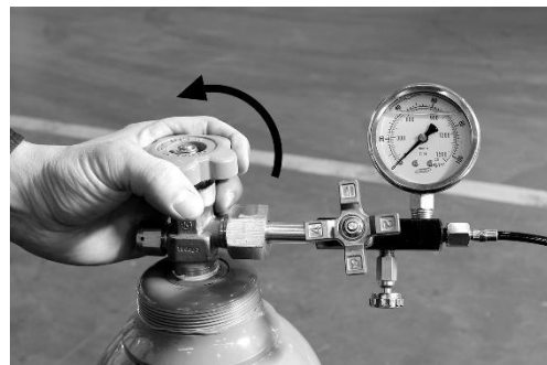
6. Abra la válvula de la bombona de gas LENTAMENTE. Open the gas cylinder valve SLOWLY. Abrirla demasiado puede dañar el manómetro. Opening it too much may damage the pressure gauge.
