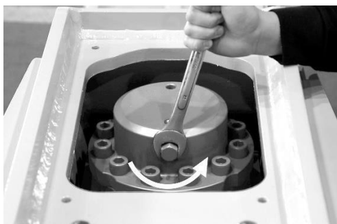
3. Retire la tapa de la válvula de aguja. Remove the needle valve cap.
