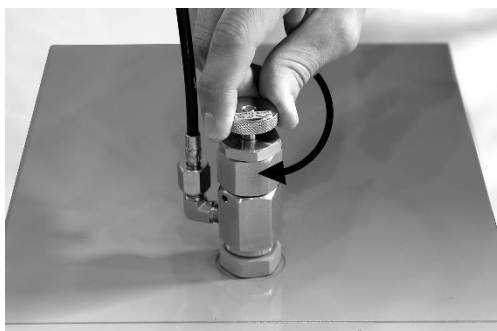
5. Apriete la sección superior del adaptador. Tighten the upper section of the adapter.
