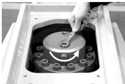
2. Retire la tapa de la válvula. / Remove the valve cap.
