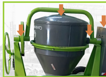
4 puntos de engrase para mejor funcionamiento
