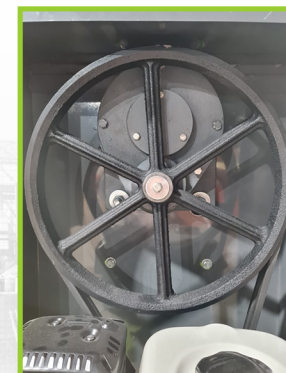
Transmisión especial que regula las RPM del motor para alargar su vida útil y hacerlo más silencioso
