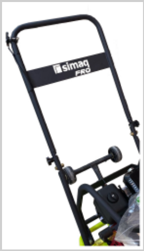
Maneral con soportes de hule que evitan la fátiga por vibración al operador
