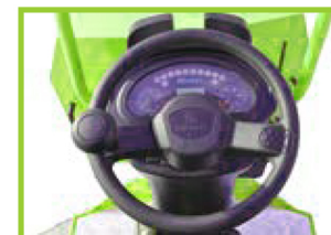
Placa de control de microcomputadora integrada con alarma de monitoreo de operación y otras funciones
