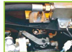
La bomba de émbolo variable hidráulica Poclain importada impulsa la velocidad continua de la máquina
