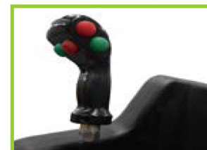
Marcha hacia adelante/atrás y vibración, todo controlado por la palanca de control integrada
