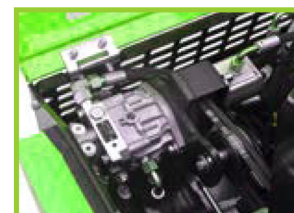
La bomba de émbolo variable de servicio liviano estadounidense impulsa la máquina a velocidad continua
