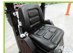
Asiento con interruptor de arranque en punto muerto, el operador se sienta hasta que el motor se detenga
