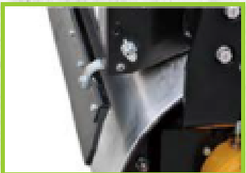
El raspador resistente al desgaste se puede levantar y fijar durante el transporte.
