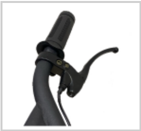
Apagador de emergencia para mayor seguridad
